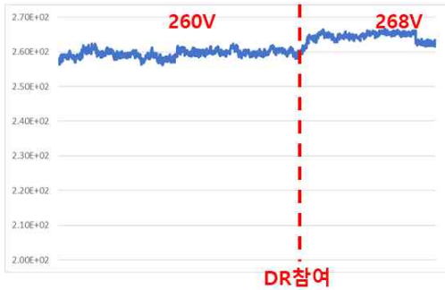
[그림 8] 시험장치에 의한 민감부하설비 공급전압 특성
